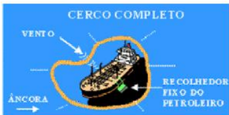
Figura 20: Esquema de cerco completo a embarcação com vazamento de óleo. A barreira deverá possuir pelo menos 3 vezes o comprimento da embarcação.
