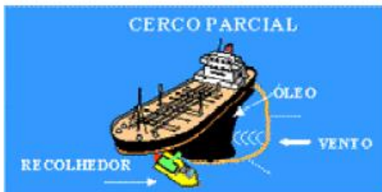
Figura 21: Esquema de cerco parcial a embarcação com vazamento de óleo, notar que o costado da embarcação serve com uma fração da barreira. A barreira deverá possuir pelo menos 2 vezes o comprimento da embarcação.
