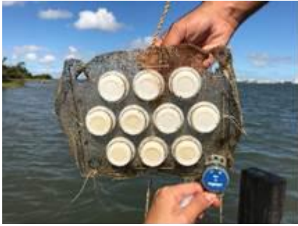
Figura 49 – Exemplo de como as unidades de DGT deverão ser expostas na água.
