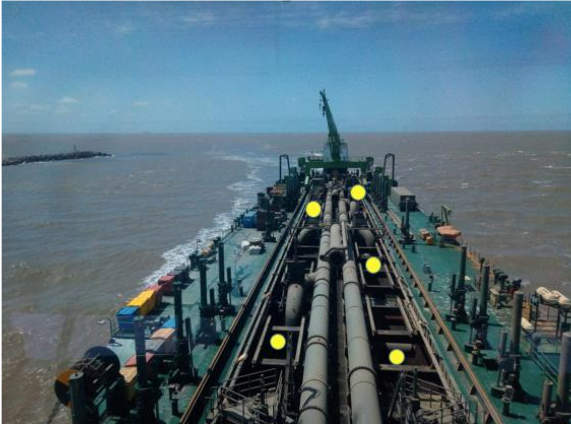
Figura 34 – Exemplo do posicionamento dos pontos amostrais na cisterna da draga TSHD Pearl River .
