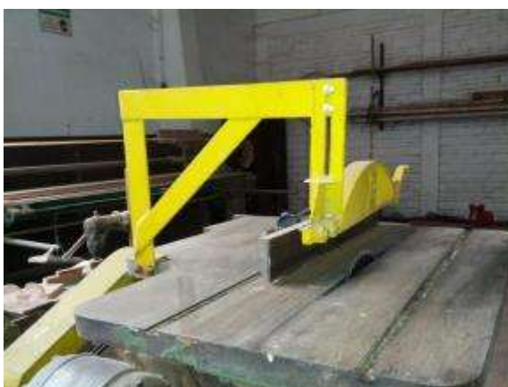
SERRA CIRCULAR COM COIFA PROTETORA MUITO ACIMA DA SERRA
