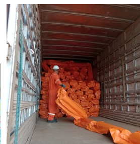
Aquisição de nova barreira de contenção utilizadas para diminuir o espalhamento de produtos, como óleo, quando ocorre algum vazamento.
