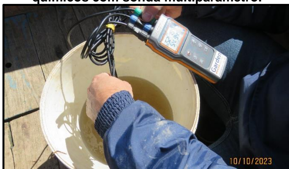
Figura 12. Aferição de parâmetros físico-químicos com sonda multiparâmetro.
