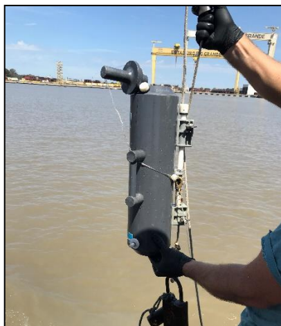
Figura 1– Detalhe garrafa tipo Niskin utilizada nas amostragens no Porto do Rio Grande.
