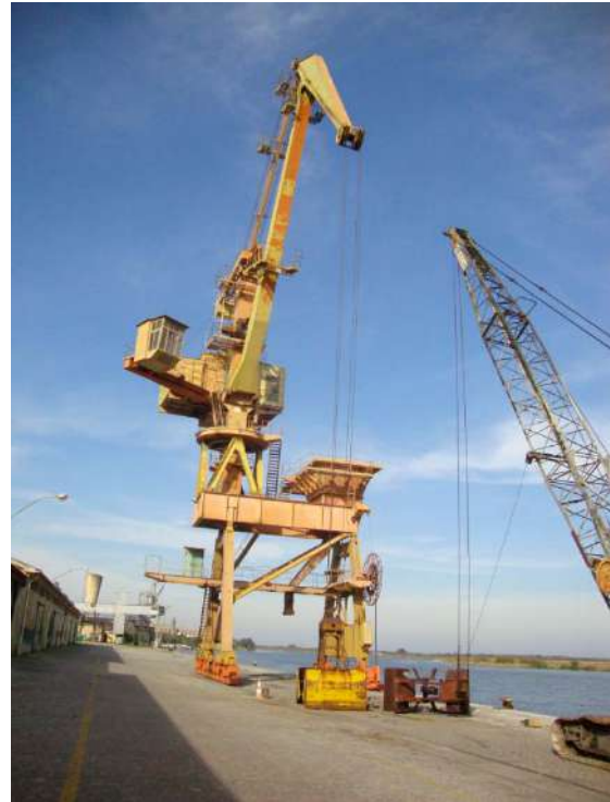
Figura 45 - Guindaste Móvel Fonte: Autores (2013)
