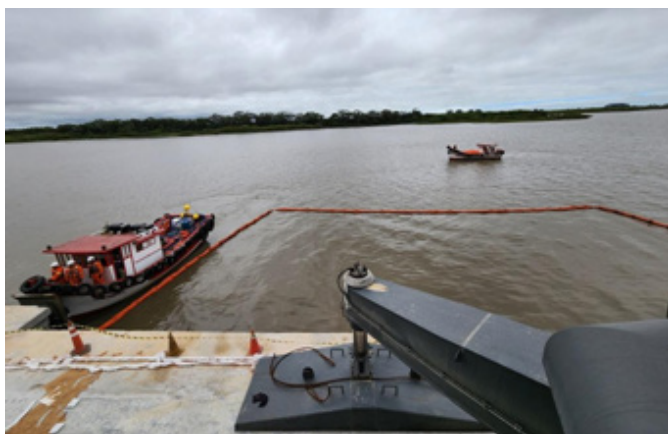
Figura 15: Instalação do cerco de contenção por parte da base de emergência ambiental.
