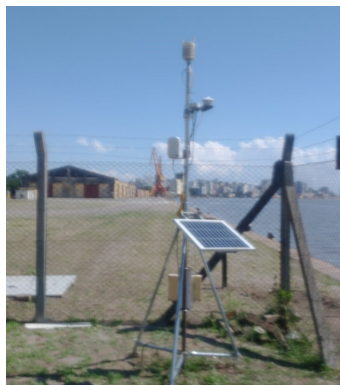
Estação meteorológica de monitoramento da qualidade do ar instalada no Porto de Porto Alegre/RS exigida pela licença ambiental da FEPAM RS.
