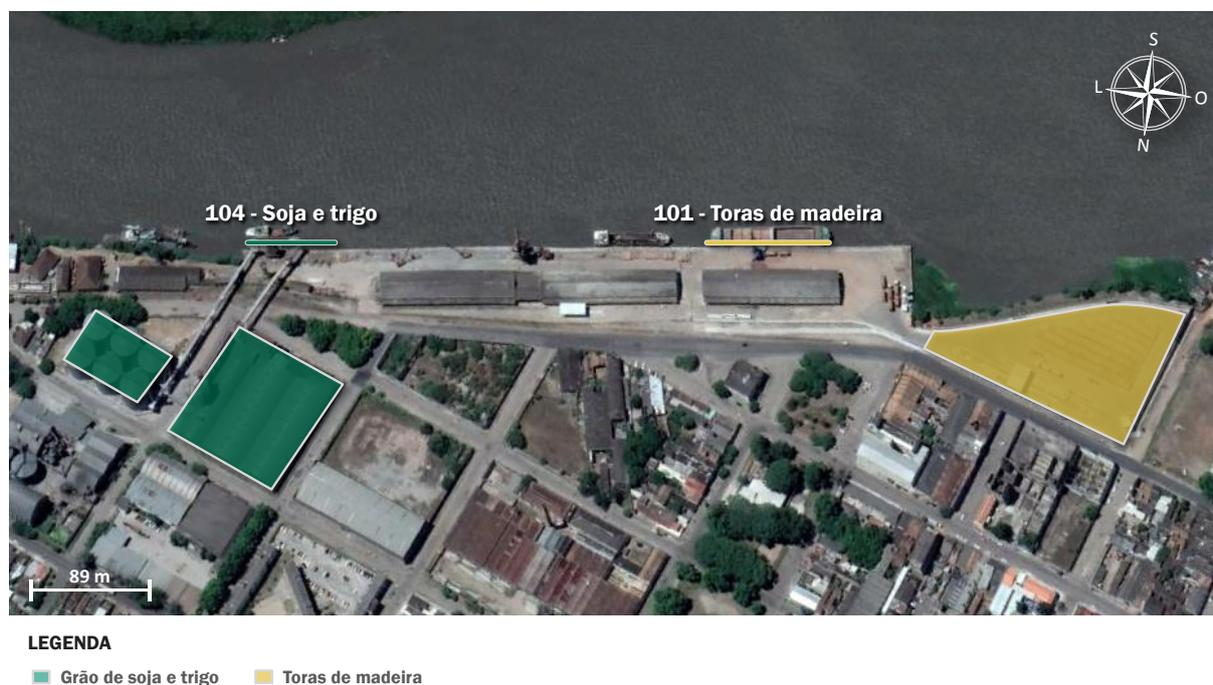
**Figura 11** – Principais destinações operacionais dos trechos de cais e armazenagem do Porto de Pelotas.
