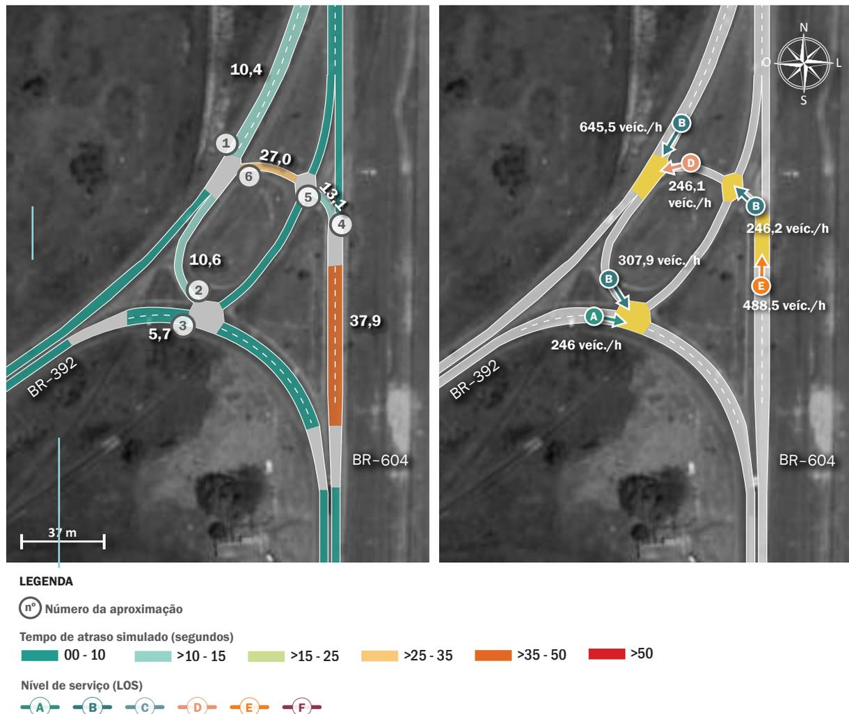
**Figura 18** – Tempos de atraso, volume de veículos e LOS nas aproximações: Interseção Trevo do Km 9 - situação atual
