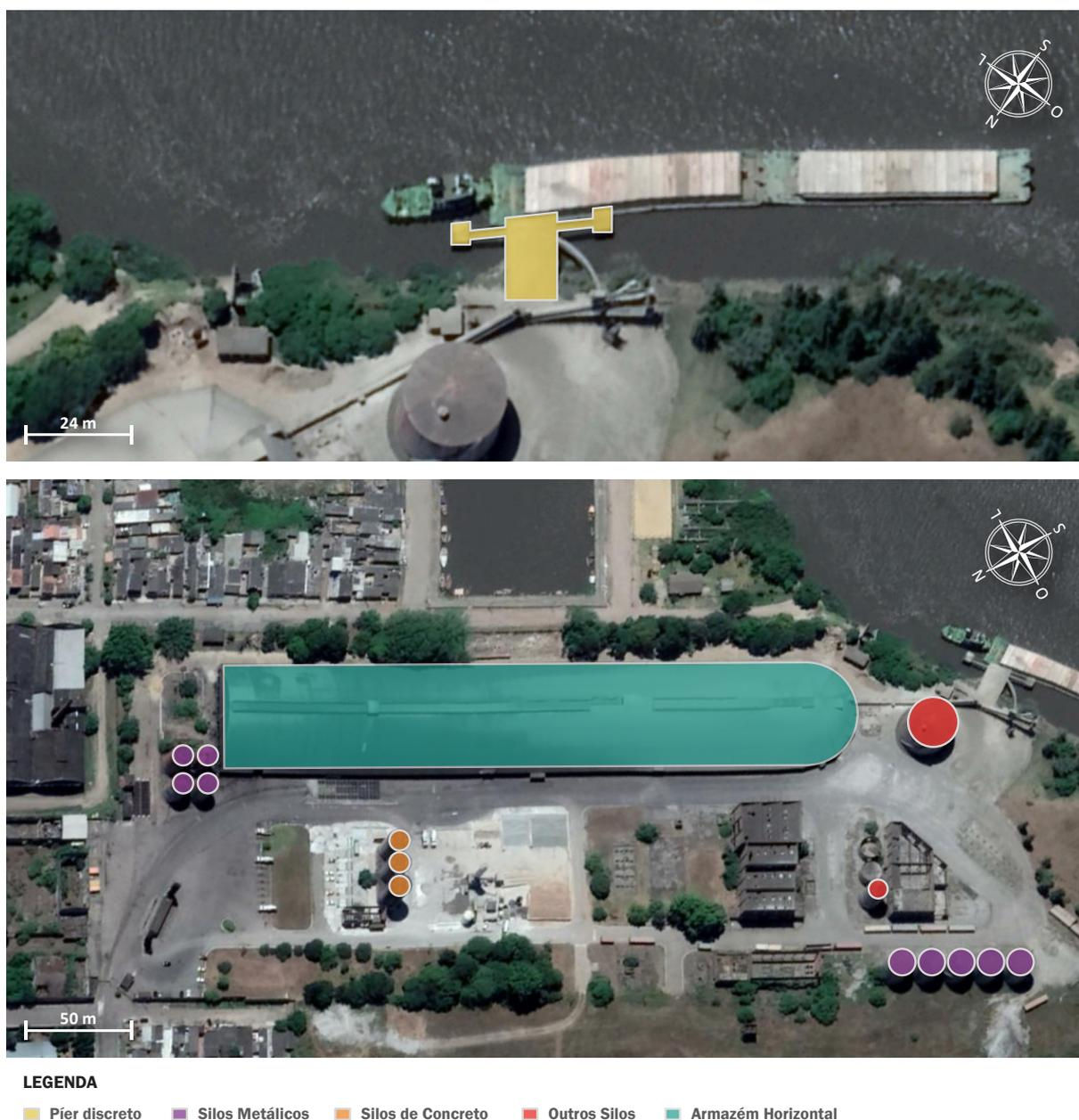
Figura 12 – Infraestrutura de armazenagem e acostagem do Terminal Logístico Pelotas
