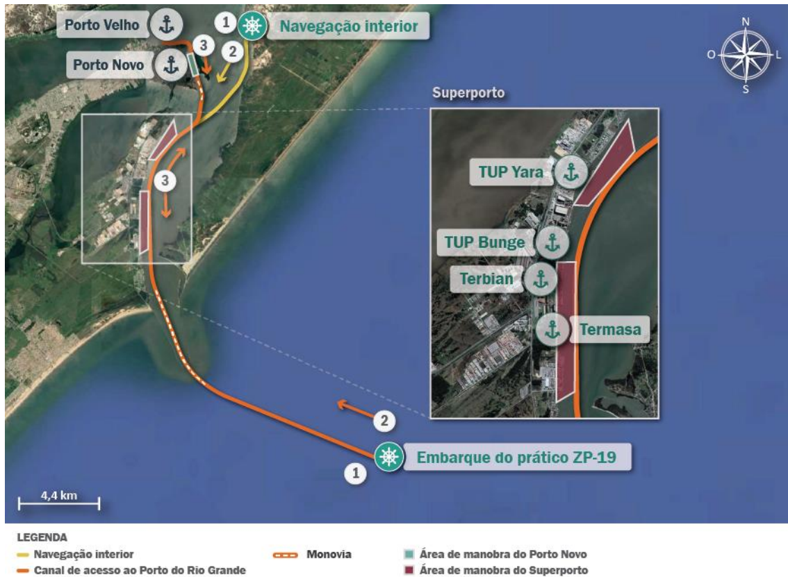
Figura 122 – Processos implementados no modelo de simulação do acesso aquaviário: Porto do Rio Grande Elaboração: LabTrans/UFSC (2019)
