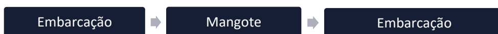
Figura 66 – Fluxograma do transbordo a contrabordo de GLP, GNL e outros gases no Porto do Rio Grande Elaboração: LabTrans/UFSC (2019)
