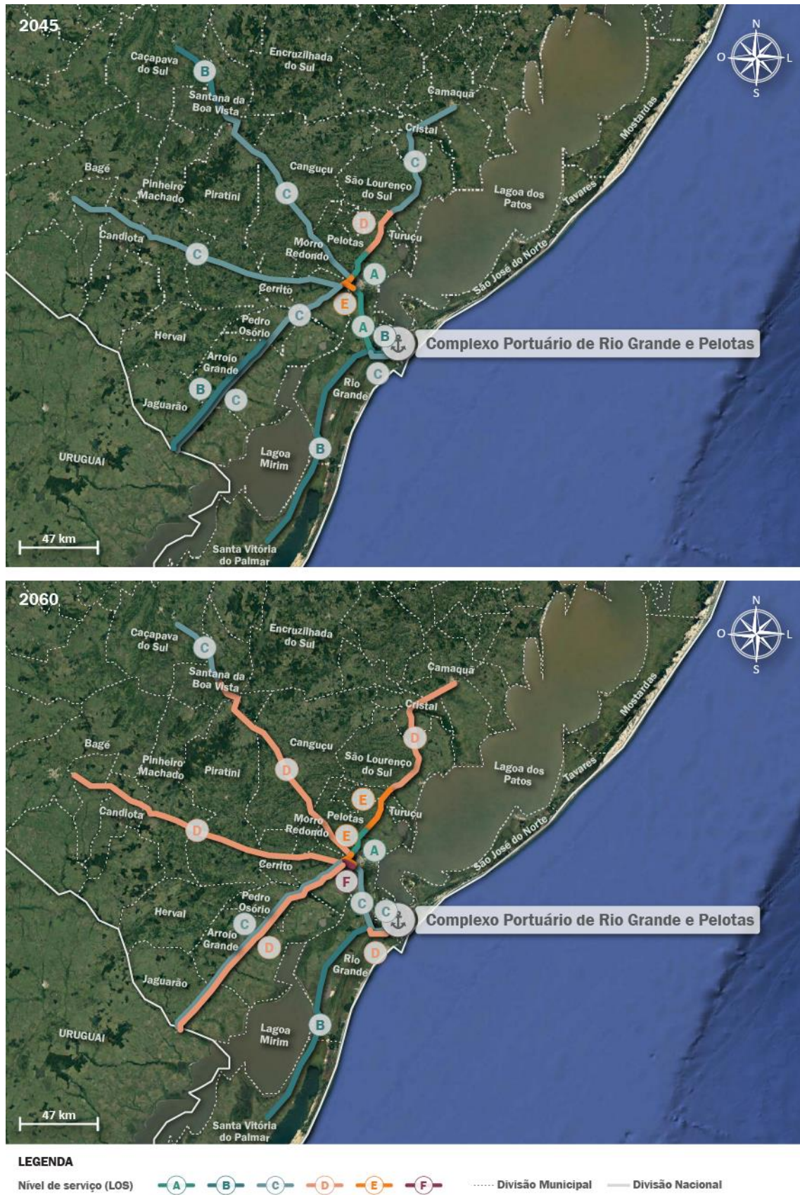
Figura 160 – LOS dos acessos rodoviários em 2045 e 2060: hinterlândia Fonte: Google Earth (2018). Elaboração: LabTrans/UFSC (2019)
