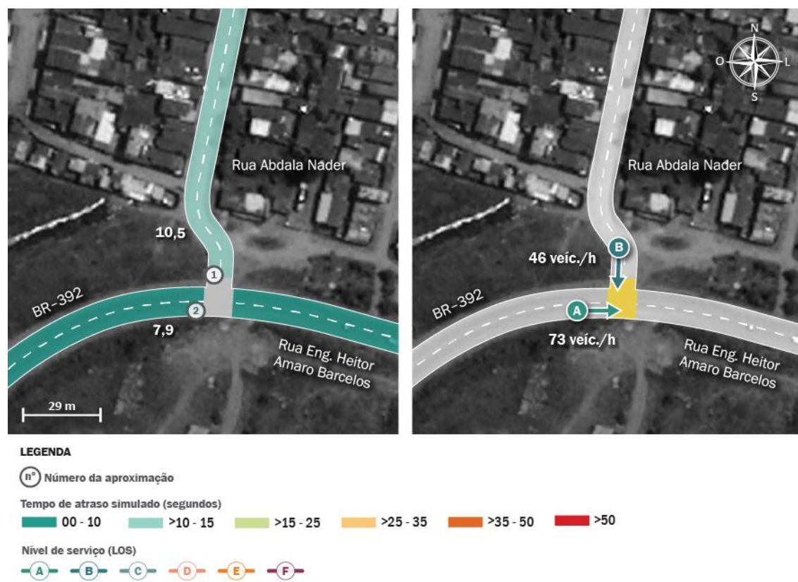
Figura 141 – Tempos de atraso, volume de veículos e LOS nas aproximações: Interseção 2 Elaboração: LabTrans/UFSC (2019)
