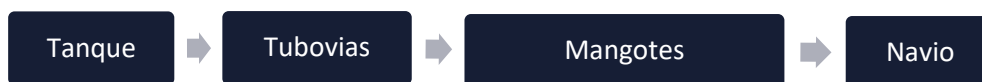
Figura 67 – Fluxograma do embarque de derivados de petróleo (exceto GLP, GNL e outros gases) no Porto do Rio Grande Elaboração: LabTrans/UFSC (2019)
