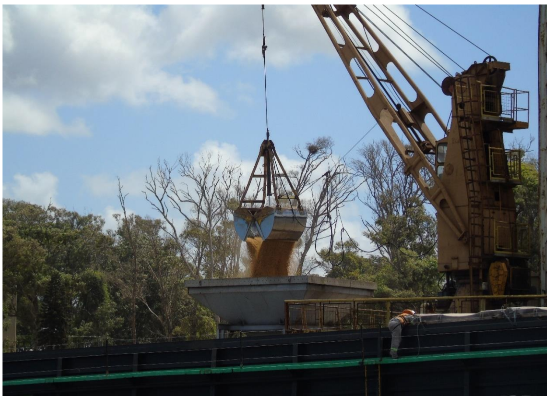
Figura 84 – Operação de desembarque de grão de soja no TUP Bunge Fonte: Imagem obtida durante a visita técnica (2018).
