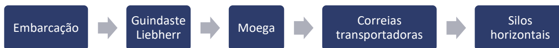
Figura 72 – Fluxograma das operações de desembarque de granéis sólidos no Terbian Fonte: Dados obtidos por meio de visita técnica e aplicação de questionário on-line (2018). Elaboração: LabTrans/UFSC (2019)
