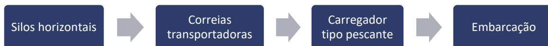
Figura 73 – Fluxograma das operações de embarque de granéis sólidos no Terbian Fonte: Dados obtidos por meio de visita técnica e aplicação de questionário on-line (2018). Elaboração: LabTrans/UFSC (2019)
