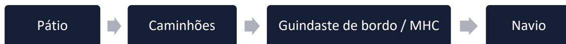
Figura 54 – Fluxograma do embarque de toras de madeira no Porto do Rio Grande Elaboração: LabTrans/UFSC (2019)
