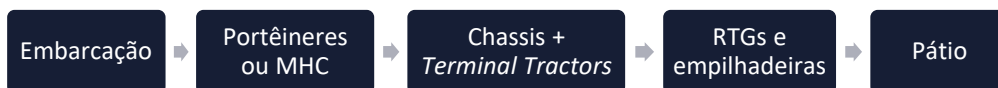
Figura 50 – Fluxograma do desembarque de contêineres no Porto do Rio Grande Elaboração: LabTrans/UFSC (2019)
