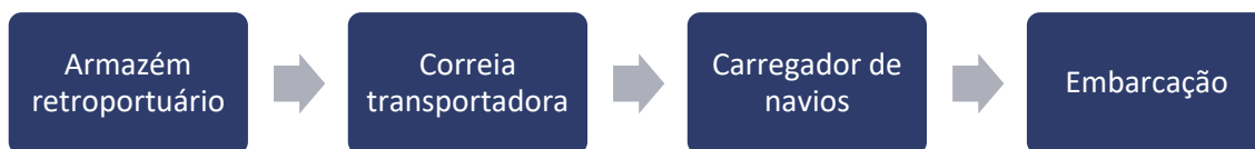
Figura 101 – Fluxograma do embarque de grãos sólidos vegetais no Porto de Pelotas Fonte: Dados obtidos durante a visita técnica e por meio da aplicação de questionário on-line (2018). Elaboração: LabTrans/UFSC (2019)
