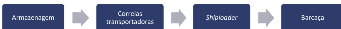
Figura 90 – Fluxograma das operações de embarque de fertilizantes no TUP Yara Fonte: Dados obtidos por meio de visita técnica e aplicação de questionário on-line (2018). Elaboração: LabTrans/UFSC (2019)
