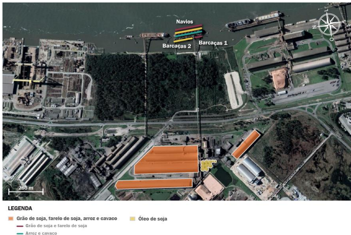
Figura 71 – Principais destinações operacionais dos trechos de cais e armazenagem do Terbian Fonte: Google Earth (2019). Elaboração: LabTrans/UFSC (2019)
