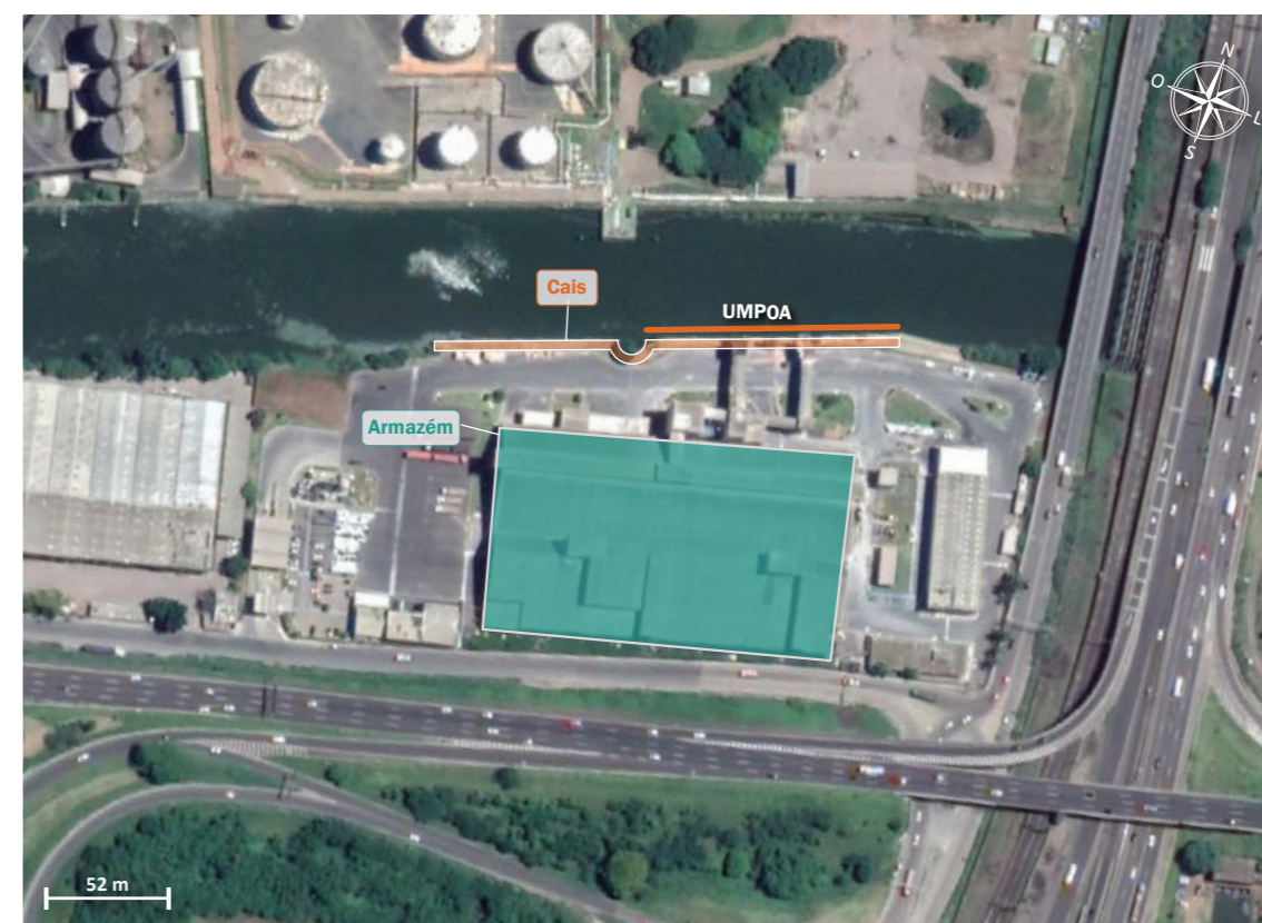
Figura 12 – Infraestrutura portuária da ETC Yara Porto Alegre Fonte: Google Earth (2019). Elaboração: Ministério da Infraestrutura (2019)
