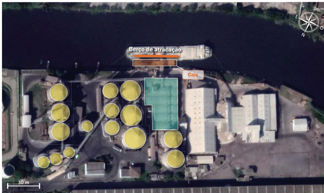
**Figura 9** – Infraestrutura de acostagem e armazenagem do TUP Oleoplan
